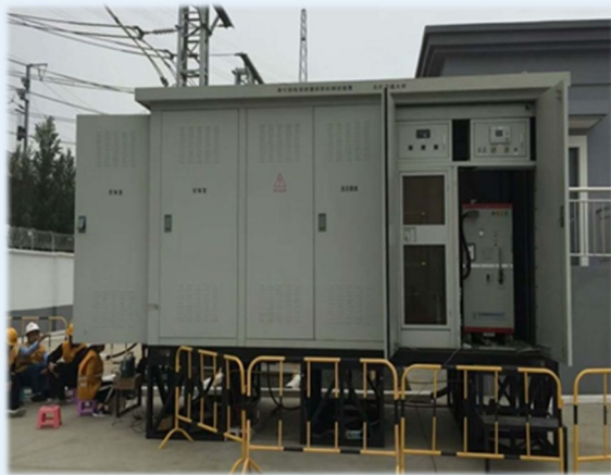
世界首套谐波阻抗测试装置
